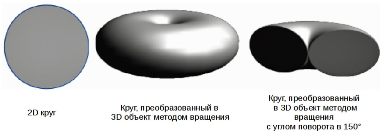
Рис. 7.13: Угол поворота 3D объекта
